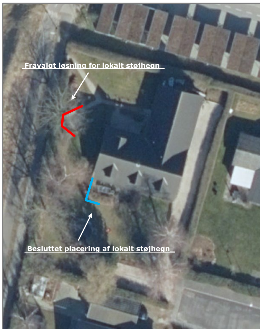
Figur 6-7. Idéskitser til lokale støjhegn hos Munkevangen 15 i Køge. Den endelige udformning af støjhegnet er angivet med den blå farve. Løsningen ved terrassen i forbindelse med huset blev valgt for at nyde gavn af den afskærmning huset bidrager med. Optegnelserne af de lokale støjhegn er ikke målfaste.
