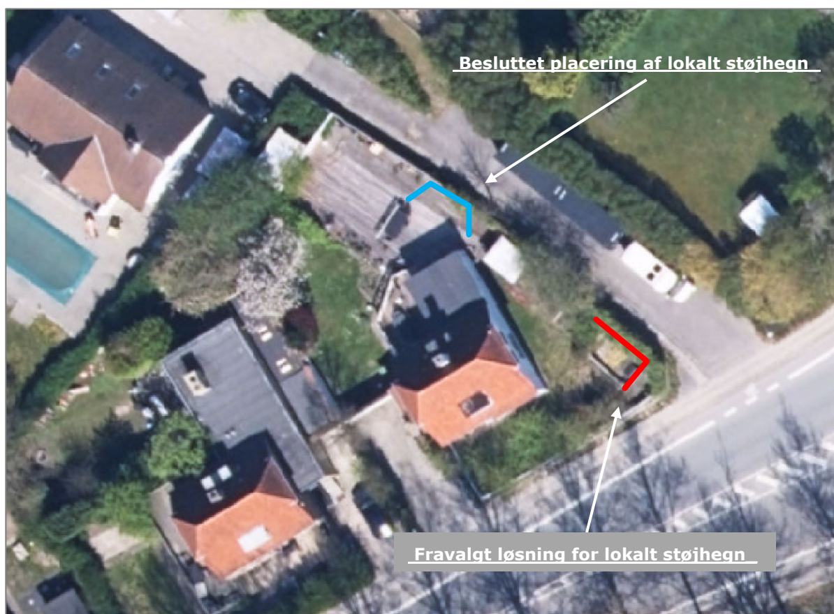
Figur 6-4. Idéskitser til lokale støjhegn hos Skovdiget 12 i Gladsaxe. Den endelige udformning af støjhegnet er angivet med den blå farve. Hegnet med rød farve blev fravalgt, da denne del af haven ikke anvendes og ikke ligger i umiddelbar tilknytning til adgang til terrassen. Optegnelserne af de lokale støjhegn er ikke målfaste.
